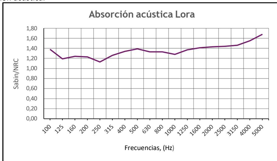
Según Normas AS ISO 354 ( $\alpha_w = 0,91$ ) y ASTM C423 (NRC = 0,90)
